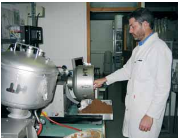
Raclage du matériel fermenté lors des opérations de vidange. (Photo MADEP/Infors)
