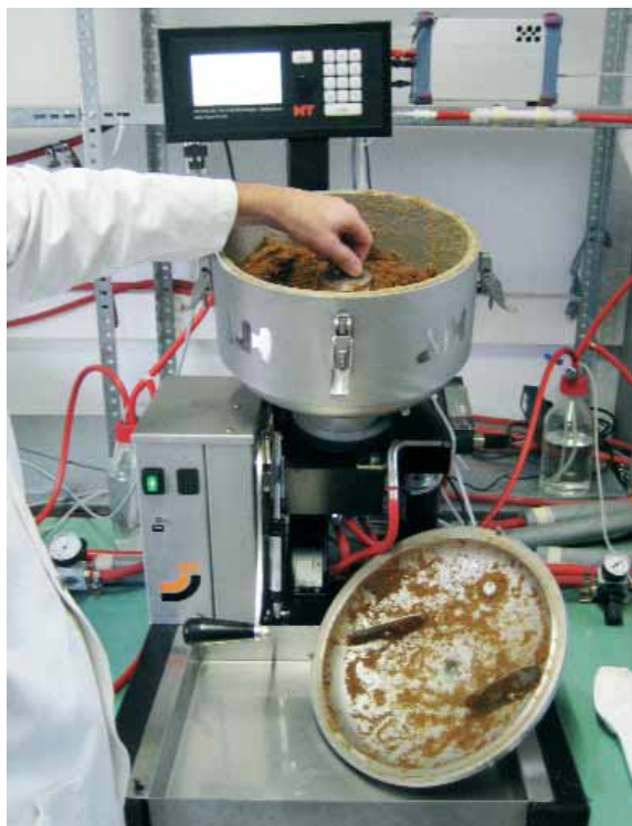
Ouverture du Terrafors lors d'opérations de surveillance et de prélèvement (ajustement du pH), d'addition de substances (nutriments) et de micro-organismes, de vérification, de remplissage, de vidange et de changement des diffuseurs. (Photo MADEP/Infors)
