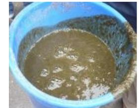
➤ **Addition des bactéries fraîches concentrées (10-20 l/1'000m3 vol. digesteur) dans la fosse d'alimentation ou les conduites de recirculation des digestats.**
